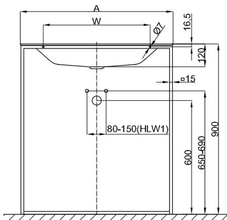
Dimensions pour installation et raccordement:
