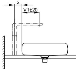
Dimensions pour installation et raccordement:
