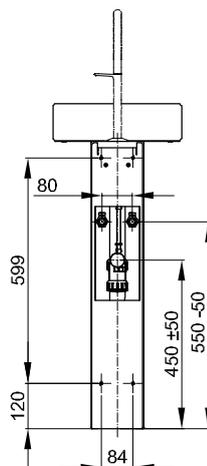
Dimensions pour installation et raccordement.
