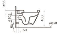
Un tuyau supplémentaire pourrait être nécessaire suivant l'épaisseur du mur.
