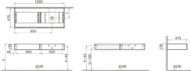
Plan pour caisson # 65728 - # 65729, # 65730 ou # 65927 - # 65929 doivent être commandés séparément.
