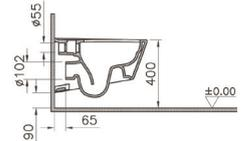
Un tuyau supplémentaire pourrait être nécessaire suivant l'épaisseur du mur.
