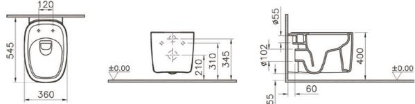
Un tuyau supplémentaire pourrait être nécessaire suivant l'épaisseur du mur.
