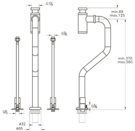
La pré-installation du raccordement de l'eau et des eaux usées dans le sol doit être fournie par le client. Pour plusieurs informations veuillez consulter notre guide d'installation.
