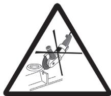
Le receveur ne doit subir aucune modification (sciage, meulage de renfort...) autre que celles prévues par le fabricant.
